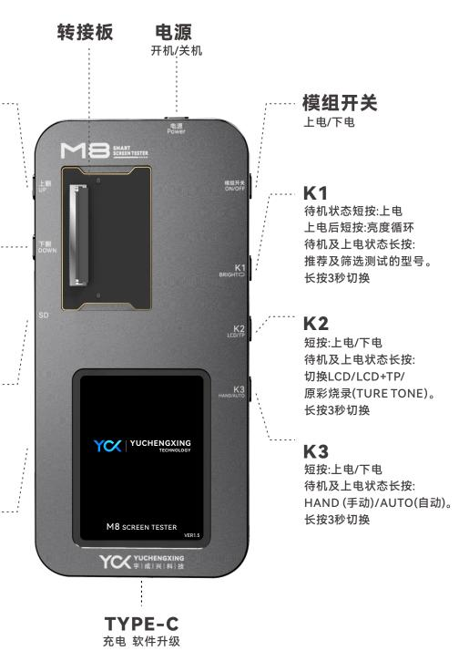
5分钟设备无操作,将自动关机,已达到更长的待机时间 备注:充电状态和上电状态,5分钟设备无操作,不会自动关机
